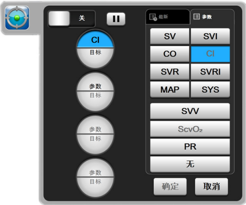
图 12-7 GDT 菜单屏幕 — 关键参数选择
