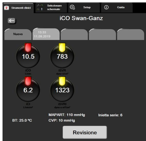
**Figura 9-7 Schermata di riepilogo della termodiluzione**
