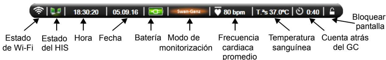
**Figura 5-17 Barra de navegación: módulo Swan-Ganz de HemoSphere**
